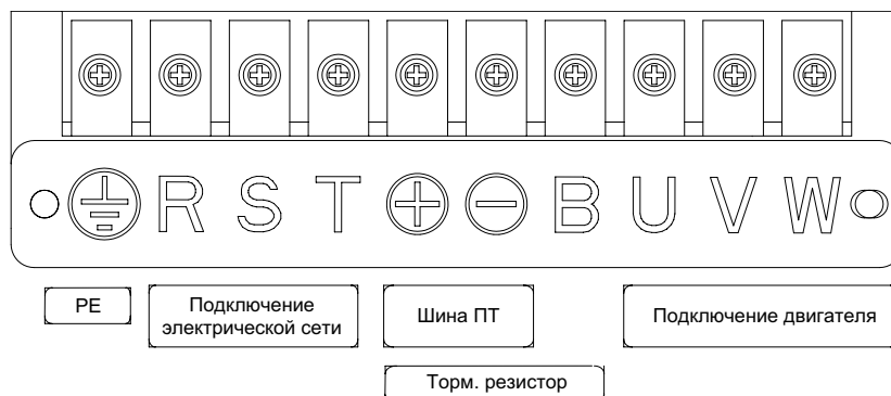
Рисунок 4.6. Силовые клеммы NVF2G-S-1.5/PS4–30/PS4
