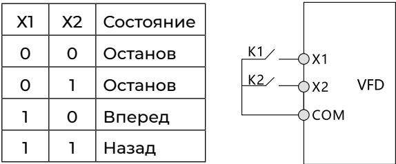
Рисунок 8.1.2. Режим двухпроводного управления 2
