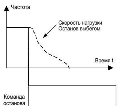
Рисунок 8.3.5. Временная диаграмма для режима останова выбегом
