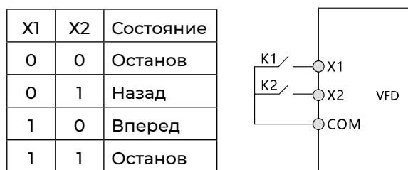
Рисунок 8.1.1. Режим двухпроводного управления 1
