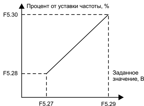
Рисунок 8.2.1. Настройка кривой аналогового входа 1
